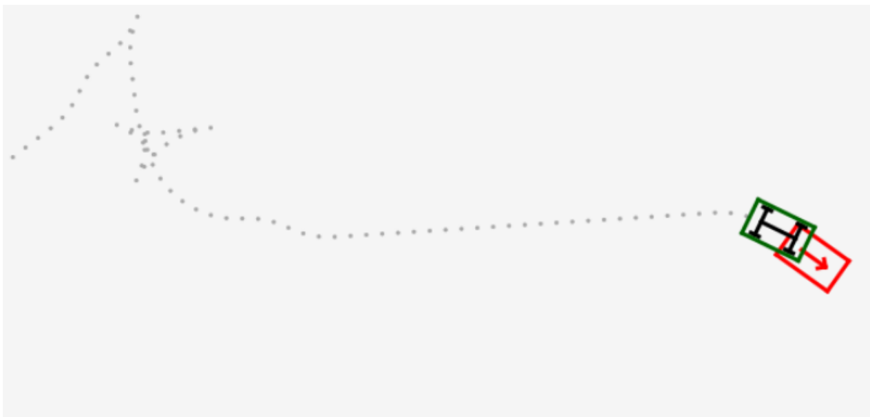
Рисунок 2.9 – Траєкторія, побудована алгоритмом «Гібридний A*» з простою cost-функцією
