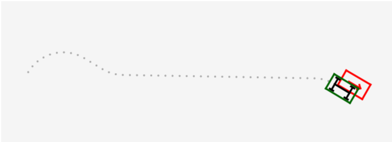
Рисунок 2.10 – Шлях, прокладений алгоритмом «Гібридний A*» з покращеною cost-функцією.
